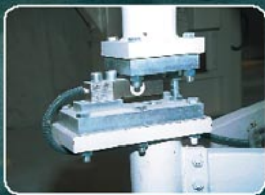
► Detalle instalación célula extensiométrica en propulsor de transporte.
