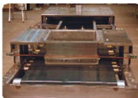
▶ Detalle zona de carga en cinta báscula dosificada.
