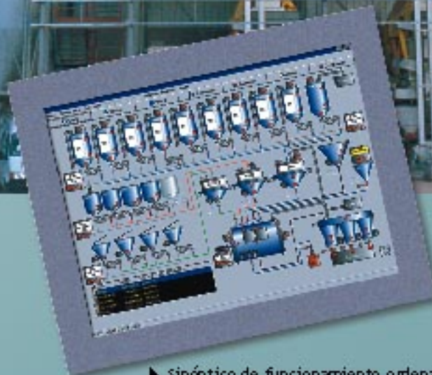
► Sinóptico de funcionamiento ordenador central de instalación automatizada de ensacado de colas.
