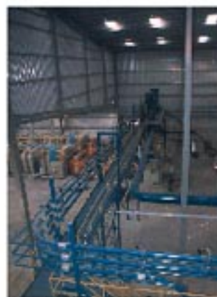
► Tubería de transporte de arcilla atomizada
