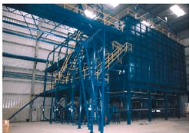
► Batería de silos de acero inoxidable para pasta blanca, roja y porcelánica.
