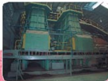
► Detalle instalación molinos de martillos.
